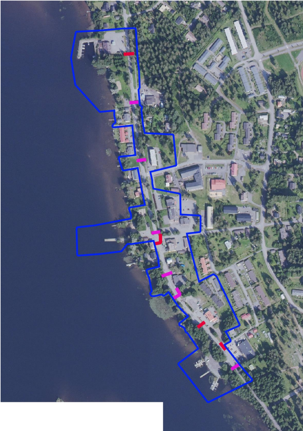
Kuva 8: Alueelle suunnitellut suojatiet. Punaisella osoitettu nykyiset suojatiet ja lilalla uudet suojatiet.
